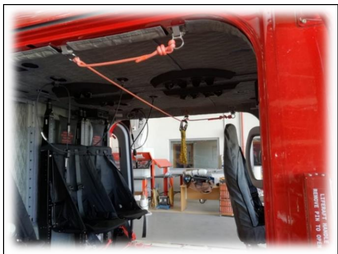
Foto: Linea di trattenuta con spezzone di corda.
