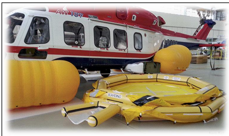
Foto: Nella foto AW 139 – particolare delle zattere di emergenza in dotazione anche sull'AW 139
